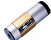
NÍVEIS DE CALIBRAÇÃO: 94DB e 114DB (1KHZ)
